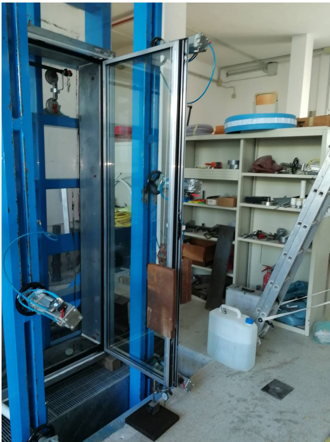
Foto 3: Campione sottoposto a prova durante i test di resistenza al carico verticale
